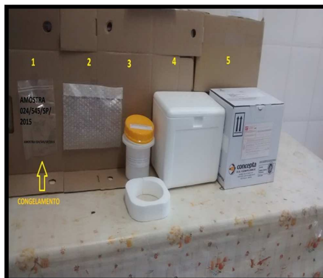
Foto 11 – Exemplo de embalagem tríplice: saco plástico e saco polibolha (1 e 2) (embalagem primária), frasco boca larga com fechamento hermético e resistente (3) (embalagem secundária), caixa isotérmica (4) (não é considerada embalagem, pois permite troca de gases) – importante para conservação da temperatura da amostra e caixa de papelão (5) (embalagem terciária)
